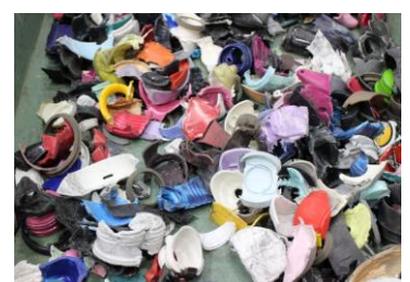
樹脂パーツ破碎後
