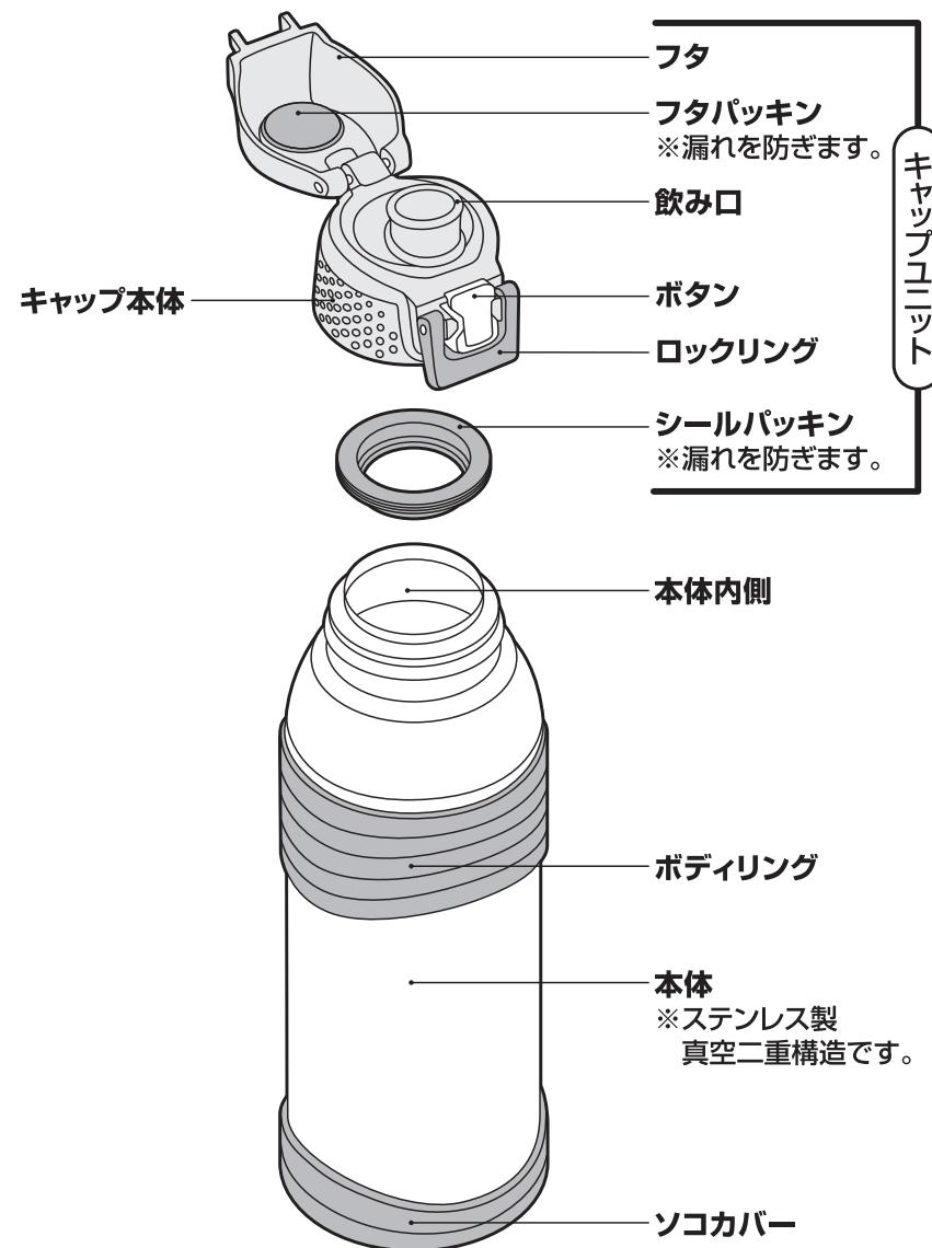
キャップユニットは2つの専用パッキンを正しく取り付けて使用してください。
